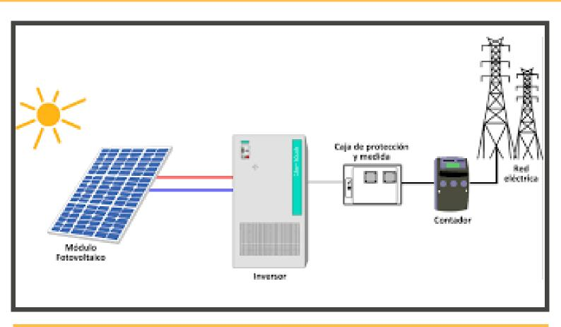
La energía eléctrica producida por los módulos en forma de corriente continua es convertida en corriente alterna e inyectada a la red a través de un elemento electrónico de potencia llamado inversor que se sincroniza con la red pública a la que se conecta. El objetivo es conseguir inyectar la máxima producción de energía diaria.
