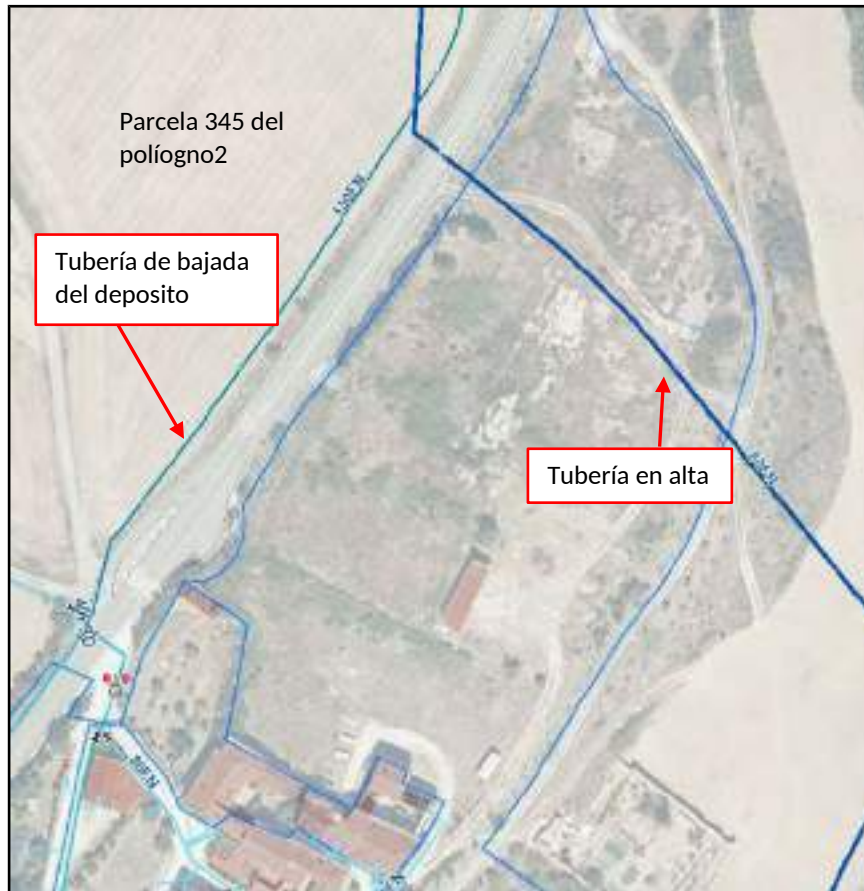
Imagen de la situación de las tuberías de abastecimiento
